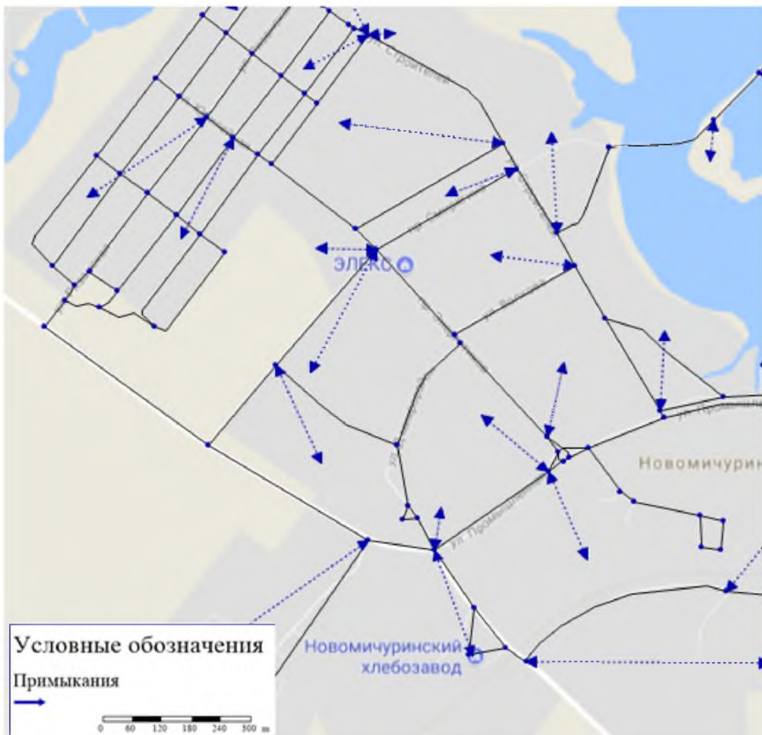
Рисунок 9 – Расстановка примыканий в центральной части города
