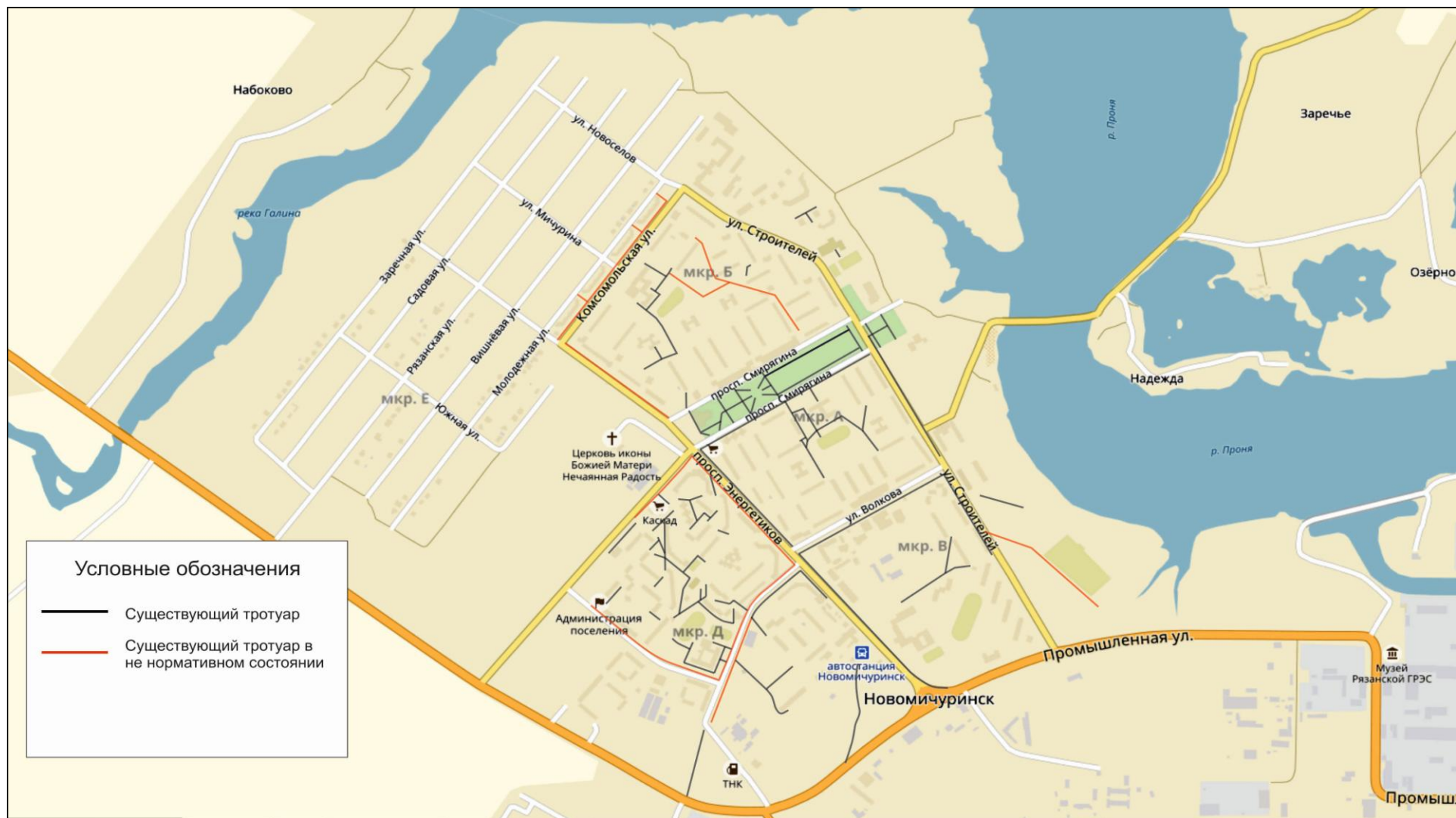
Рисунок 9 – Состояние тротуаров в Новомичуринском городском поселении
