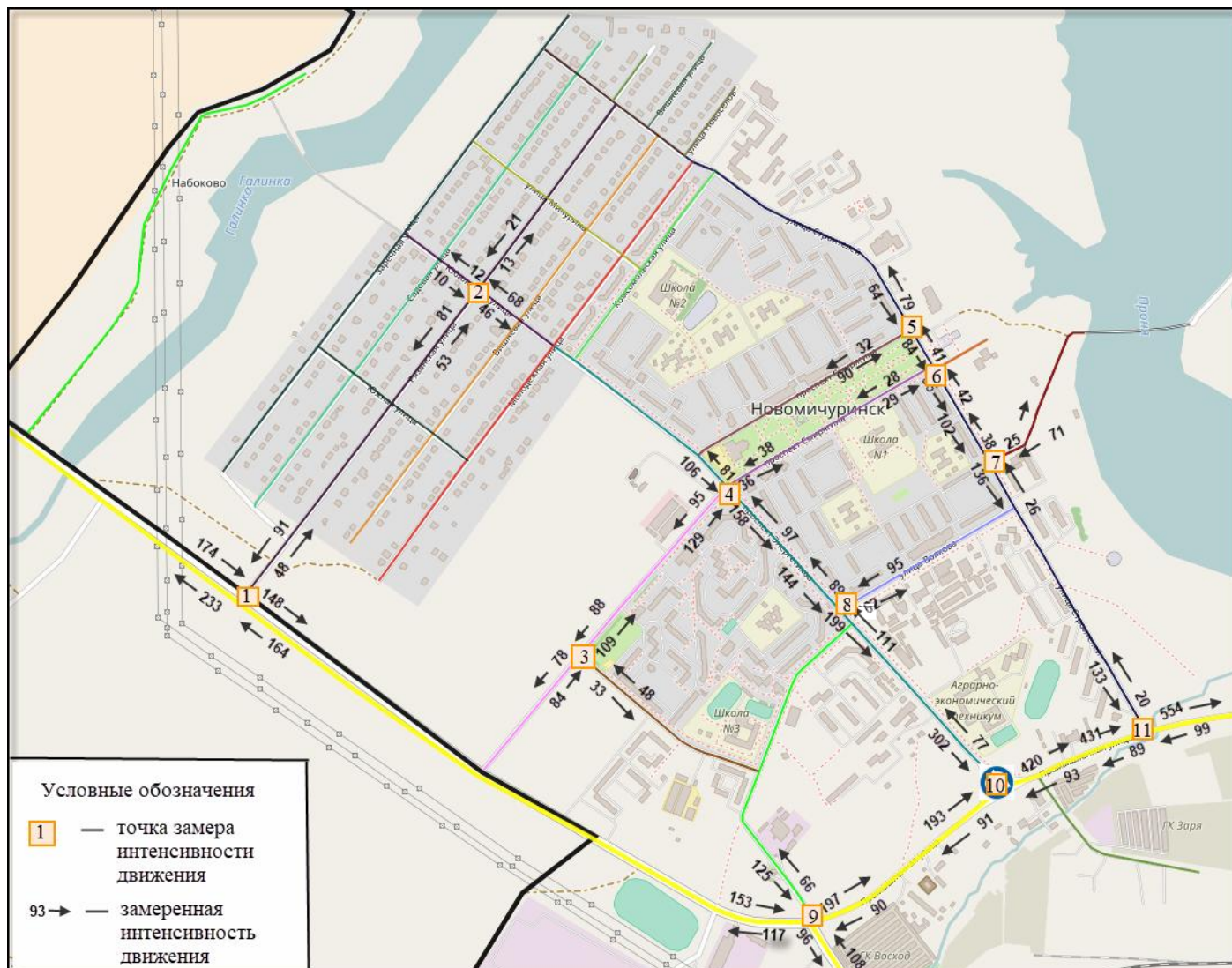
Рисунок 3 – Картограмма точек замеров и замеренная интенсивность движения транспорта на перекрёстках автодорог Новомичуринского ГП
