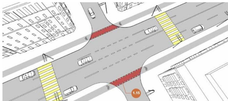
Рисунок 18 – Схема примыкания к улиц с велосипедной полосой
