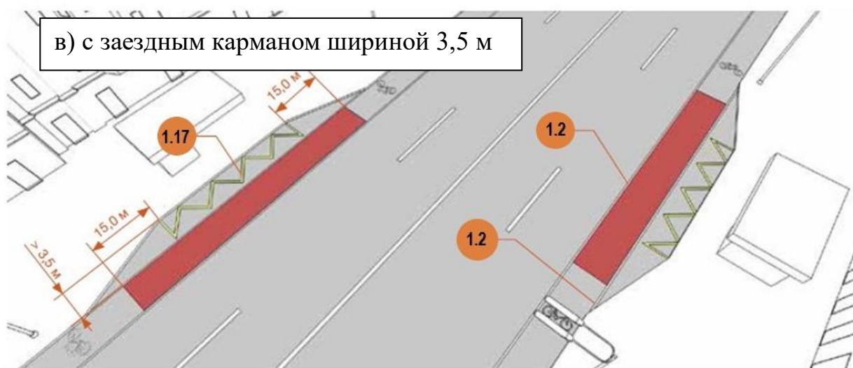
Рисунок 44 – Схемы размещения велосипедной полосы у остановки общественного транспорта
