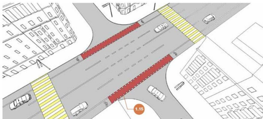
Рисунок 27 – Схема примыкания к улице с велосипедной полосой
