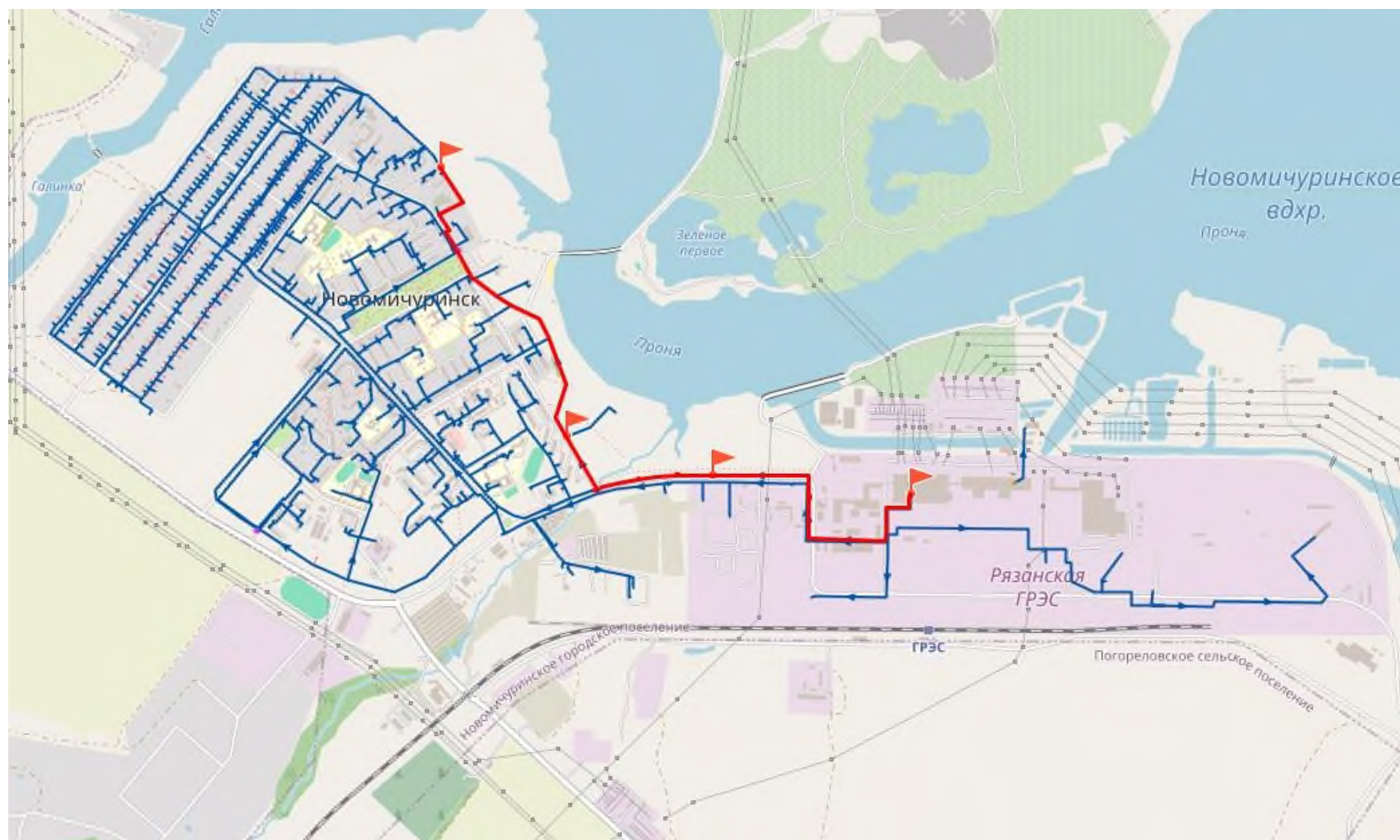
Рисунок 4.3. Путь построения пьезометрического графика от Рязанской ГРЭС до тепловой камеры ТК VII-3 ОЗП 2034/2035 гг.
