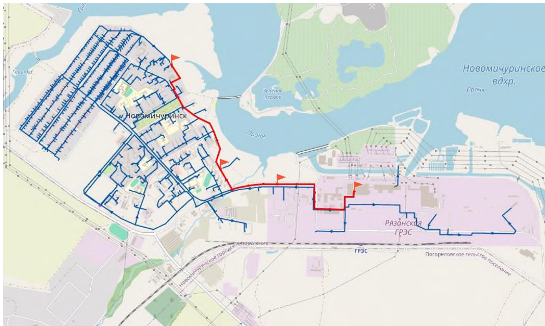
Рисунок 1.9. Путь построения пьезометрического графика от Рязанской ГРЭС до тепловой камеры ТК VII-3 2024/2025 гг.
